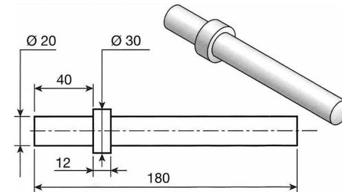
Calculer sa masse  $M = \rho \times \mathcal{V}$  où  $\rho = 7\,800 \text{ kg.m}^{-3}$  est la masse volumique de l'acier et  $\mathcal{V}$  le volume de l'arbre.
