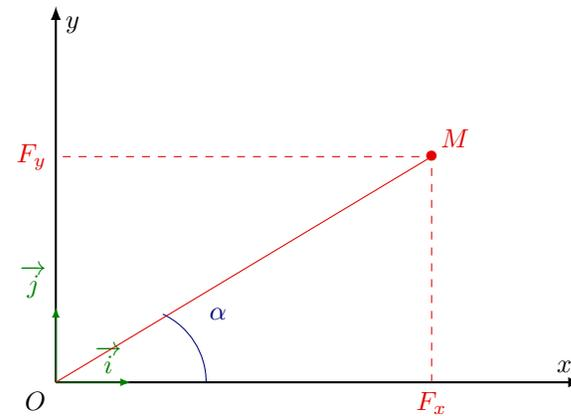
A l'aide du schéma ci-dessus, calculer les composantes  $F_x$  et  $F_y$  d'une force d'intensité 22,6 daN avec  $\alpha = 34,2^\circ$ .
