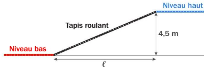
Le tapis roulant sélectionné, représenté ci-dessus, possède une vitesse de roulement de  $0,8m/s$  et une pente maximale de 10%. La distance entre les deux niveaux est de  $4,5m$  et on note  $l$  la longueur au sol du niveau bas occupée par le tapis roulant. Donner un encadrement de la longueur  $l$  pour que les contraintes soient satisfaites. On pourra utiliser la calculatrice.
